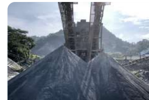
Lapis Pondasi Bawah (LPB) Lower Base Layer (LPB)
